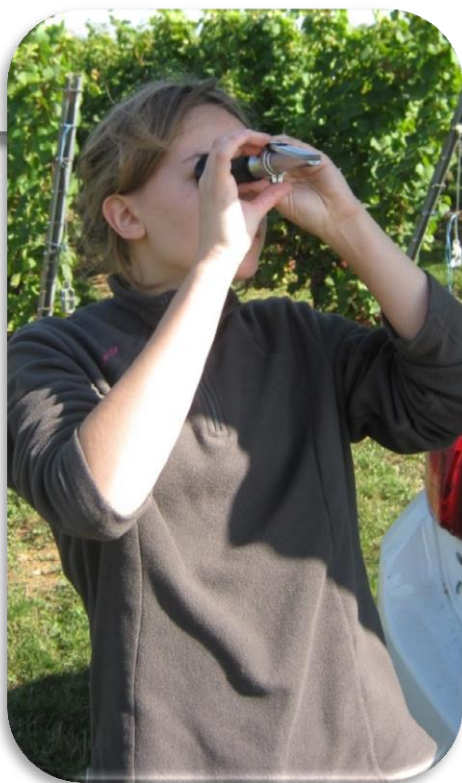
Juliette contrôlant le degré de maturité du raisin avec le réfractomètre
